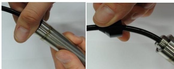
Fig. 42: Desaflojar la tuerca y empujarla a través del cable.
